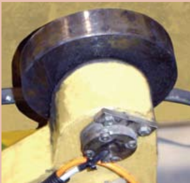
La célula de carga del brazo secundario se monta directamente en el rodillo de bobinado
